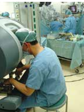
ダヴィンチを使用した手術の様子(秋田大学医学部附属病院にて) 手前が執刀医、奥が患者さんと執刀医の動きにあわせて手術鉗子を動かすロボットアーム。 An operation being performed using the da Vinci Surgical System at Akita University Hospital
