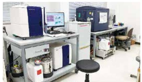
写真右側 セルソーター FACS Aria III：生体中の微量な細胞群を高速に選別し取得することができます。
