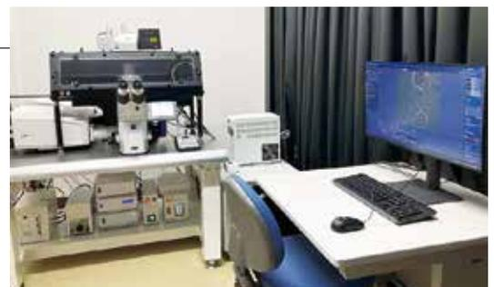
超解像共焦点レーザー顕微鏡LSM980 with Airyscan2：生細胞もダメージを少なく120nmの分解能で超解像イメージングが可能。
